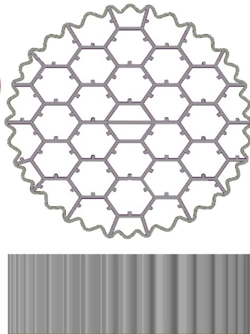
Projetados como uma opção de melhor desempenho, a Biomídia 800 possui suas paredes abertas e, no interior de cada peça existem reforços diametrais possibilitando grande resistência mecânica e baixa perdas de carga. Suas aberturas permitem acesso total de gases e líquidos ao seu interior, e os reforços proporcionam aumento de resistência estrutural e área superficial adicional de contato entre gás e líquido.
